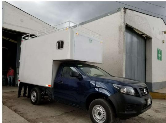
Las cajas secas y carrocerías que fabricamos cuentan con muchas características que superan a la competencia, entre ellas son mas ligeras y resistentes debido a que las paredes de fibra de vidrio soportan golpes sin abollarse y en caso de una colisión la reparación se hace en muy poco tiempo y no es necesario reemplazar paneles sino simplemente resanarlos.
